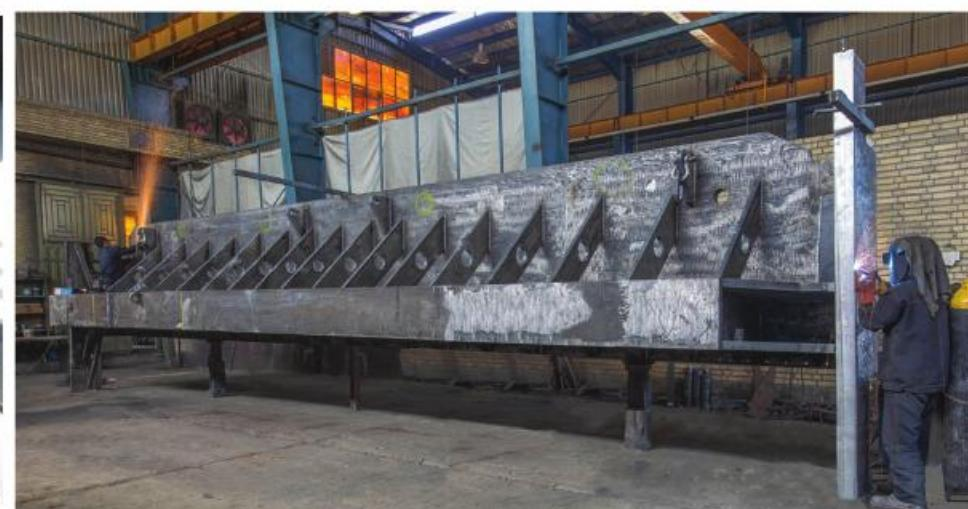
این شرکت برای اولین بار در ایران اقدام به طراحی و ساخت دستگاه گیوتین ۱۲ متری با قابلیت برش تا خاخصات ۱۰ میل بر نموده است. بعلت سنگینی استراکچر، این دستگاه بصورت چند تکه طراحی و ساخته می شود. از این دستگاه می توان جهت برشکاری قطعات بلند در صنعت شاسی سازی، سوله سازی و برجهای روشنایی استفاده نمود.
